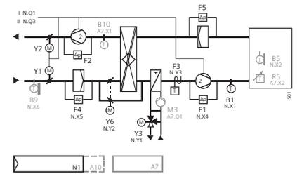
Управление температурой приточного воздуха при помощи рециркуляционных заслонок и регистром горячей воды.
